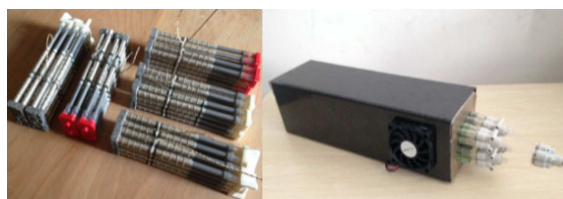
图 3 MT-SOFC 集成的丙烷发电系统
